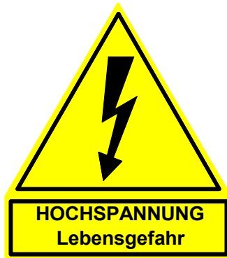
Abb. 3: Blitzpfeil und Warnschild an Hochspannungsanlagen
